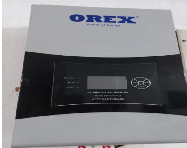
شكل (7) جهاز تحكم هجين شبكة - شمس -بطاريات (1-4 كيلوات)
