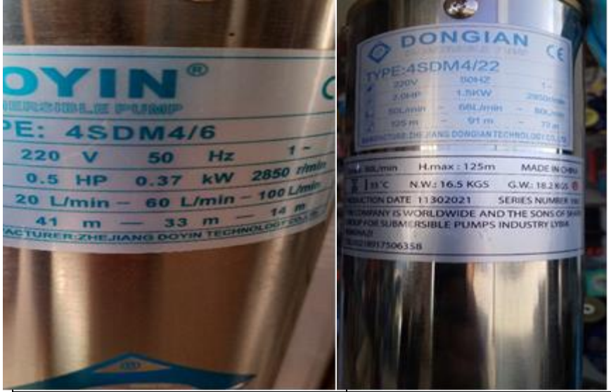
شكل (6) المضخات الغاطسة المركبة بالموقع
